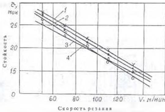
Рис.2. Зависимость  $T=f(v)$  для материалов: 1 - (Cu-Sn-C); 2 - (Fe-P-S); 3 - (Fe-Mo-S); 4 - (Fe-C)
