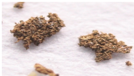
Նկ. 3. Փորձ 3: Ոսկու համաձուլվածքի մանրակառուցվածքը, խոշորացումը - x 200
