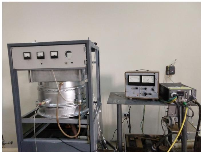
Рис.1. Экспериментальная система получения плазмы.
