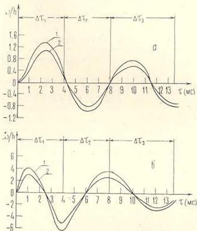
Фиг. 3. Зависимости от времени а) прогиба, б) радиальной составляющей скорости верхней точки панели: 1—при пренебрежении влияния скоростей движения элементов панели на взаимодействие с ней среды, 2—с учетом этого влияния.  $\Delta\tau_i$ —интервал времени пробега волны на расстояниях, кратных  $2H$  (среда варианта № 3,  $h/R = 0,01$ ).
