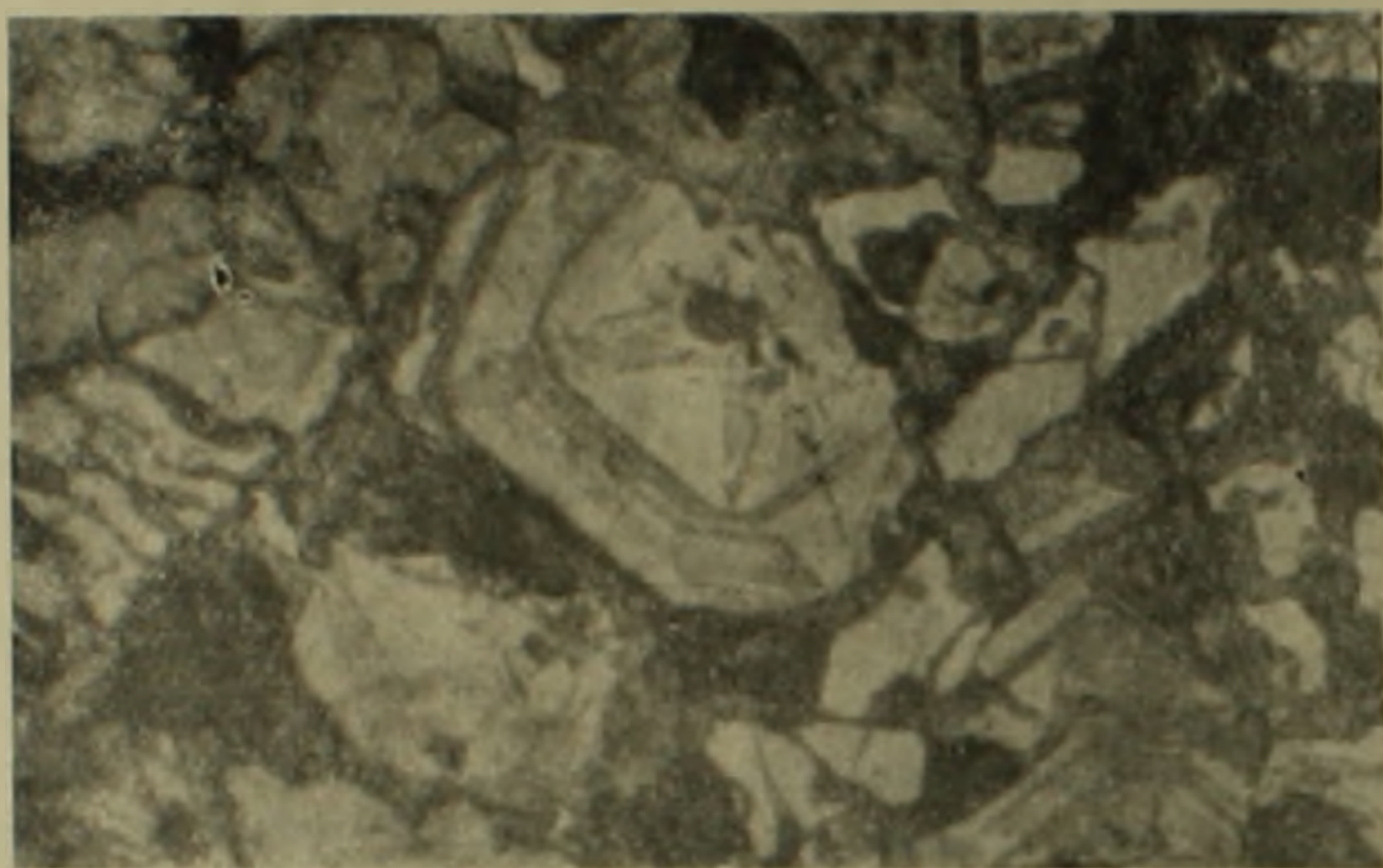
Рис. 1. Зональное строение метакристаллов магнетита. Полированный шлиф. Протравлено HCl; николи параллельны. \times 120
