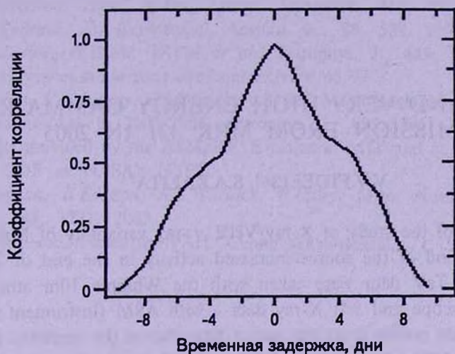
Рис.2. Корреляция между временами прихода синхротронной и обратной комптоновской компонент излучения. Положительные задержки означают предшествование потока \gamma -лучей потоку рентгеновских лучей.
