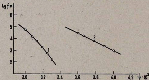
Рис. 3. Зависимость \lg f_m от \frac{1}{T} дипольно-сегментальных (1) и дипольно-групповых (2) потерь ГХНК.
