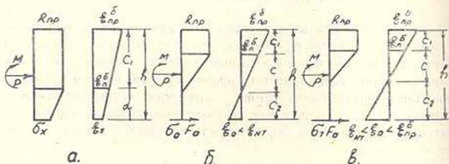
Рис. 2. Напряженные состояния несymmetricно-сжатого железобетонного элемента прямоугольного сечения: а) I; б) II; в) III.
