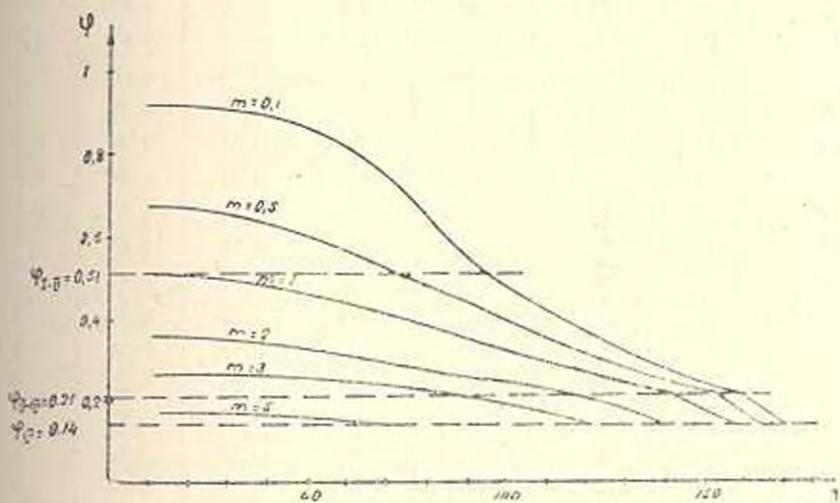
Рис. 3. Значения  $\varphi = \varphi(\lambda, m)$  для внецентренно-сжатых железобетонных колонн прямоугольного сечения, вычисленные по предлагаемой методике. Штриховые линии показывают границы областей характерных напряженных состояний.
