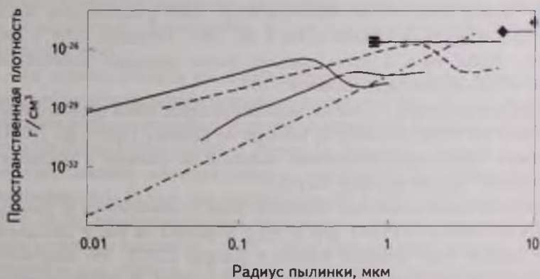
Рис.9. Распределение пространственной плотности пыли в зависимости от радиуса пылинки в оболочке сверхновой – штрих-пунктир, в межзвездной среде с углеродной и силикатной пылью – черная сплошная кривая, в межзвездной среде с ледяной пылью (иная нормировка) – черный пунктир, внутри Солнечной системы по данным аппарата Ulysses – серая сплошная кривая, по данным аппарата New Horizons – квадрат с указателем неопределенности, по данным аппаратов Pioneer – ромбы с указателем неопределенности.
