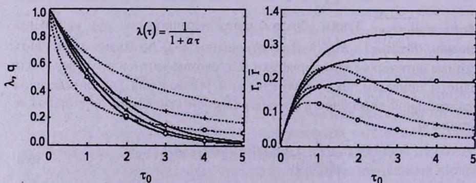
Рис.4. Левый снимок - коэффициенты рассеяния  $\lambda(\tau) = 1/(1+a\tau)$  (пунктир) и коэффициенты пропускания (сплошные линии); правый снимок - коэффициенты отражения соответствующие освещению справа и слева на рис.2. Кривые без значков относятся к случаю  $a = 0.5$ , крестиками и кружками обозначаются кривые соответственно для  $a = 1$  и  $a = 2$ .
