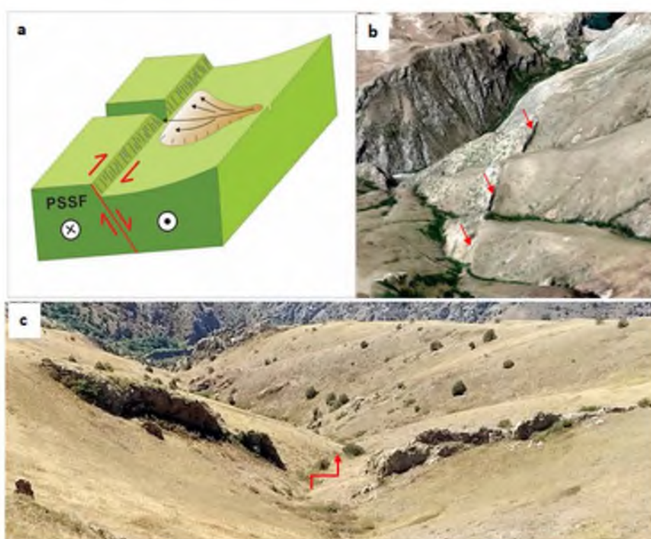
Рис.7. Сейсmodамбирование и смещения системы левых притоков р. Воротан при пересечении ими активной ветви PSSF-9: 3D модель (а), ортофотоснимок (b), иравосдвиговое смещение русла и эрозионный размыв сейсmodамбы (с) (июлевой снимок).
