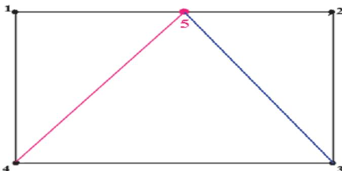
Рис. 5. Сетка из рис. 3 после применения операции “флип”
