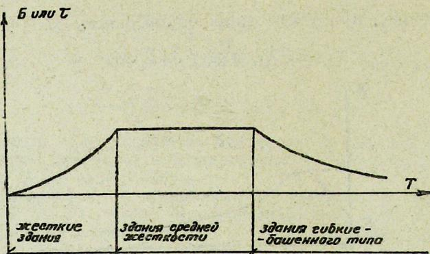
Фиг. 3. График зависимости напряжений от жесткости сооружений.
