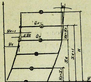
Фиг. 1. Схема деформации сдвига.
