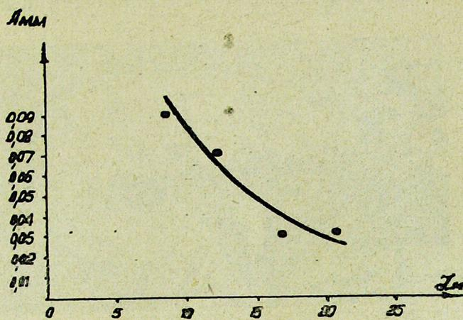
Фиг. 3. Зависимость амплитуды колебания грунта (гравия) от расстояния до источника возбуждения.
