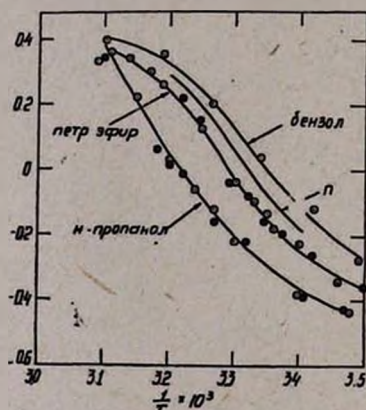
Рис. 2. Влияние температуры на проницаемость монослоев 1-гексадеканола, нанесенных из кристаллика, а также из растворов в н -пропанол, петролейном эфире и бензоле.
