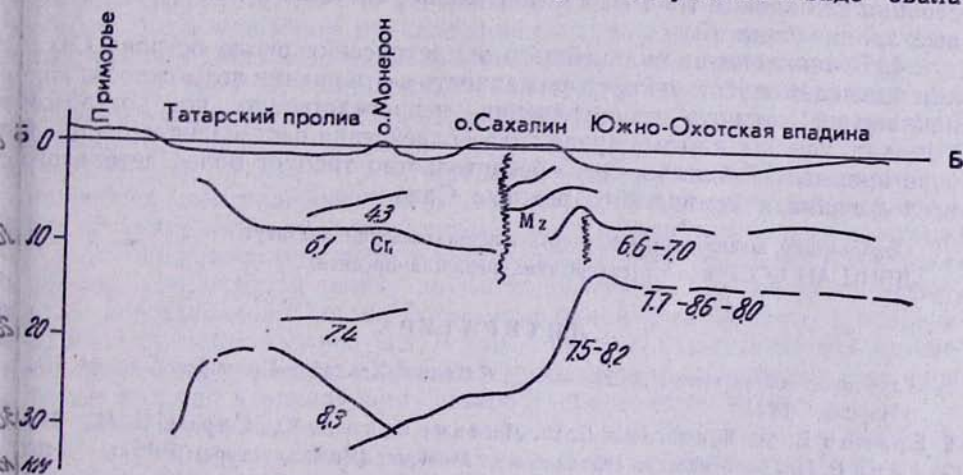
рис. 3. Глубинный профиль по линии Б—Б (рис. 1). По [1]. Указаны скорости продольных сейсмических волн в м/сек
