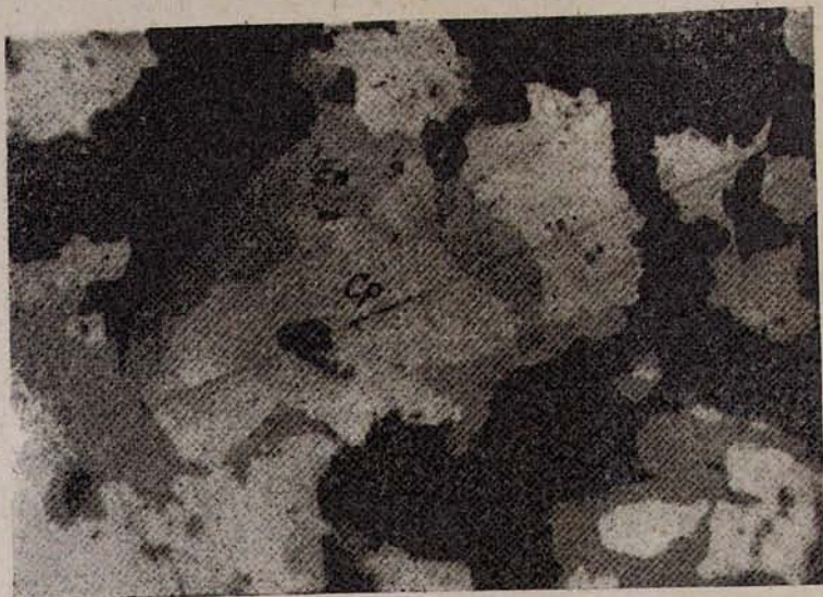
Фиг. 4. Энаргит (серое) цементирует и частично замещает обломки халькопирита (белое). Черное — кварц. Ув. 120. Без анализатора.
