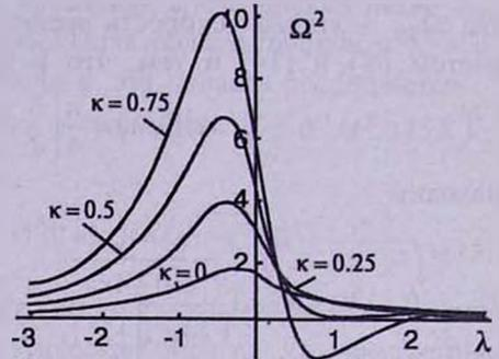
Рис.1б. Зависимость  $\Omega^2(\lambda)$  для дисков с  $\lambda = 0; 0.25; 0.5; 0.75$ .
