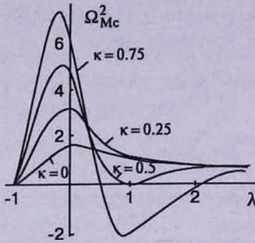
Рис.1а. Зависимость  $\Omega_{Mc}^2(\lambda)$  для дисков с  $\lambda = 0; 0.25; 0.5; 0.75$ .
