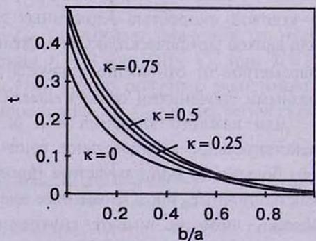
Рис.3д. Параметр  $t(b/a)$  для  $\Omega_-$ -дисков.
