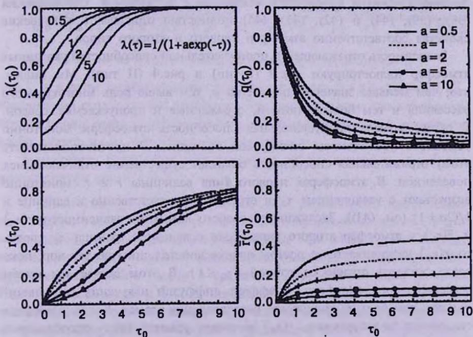
Рис.3. Зависимость коэффициентов отражения и пропускания от оптической толщины и значений параметра  $a$  для атмосферы первого типа ( $\lambda(\tau_0) = 1/(1 + ae^{-\tau_0})$ ).
