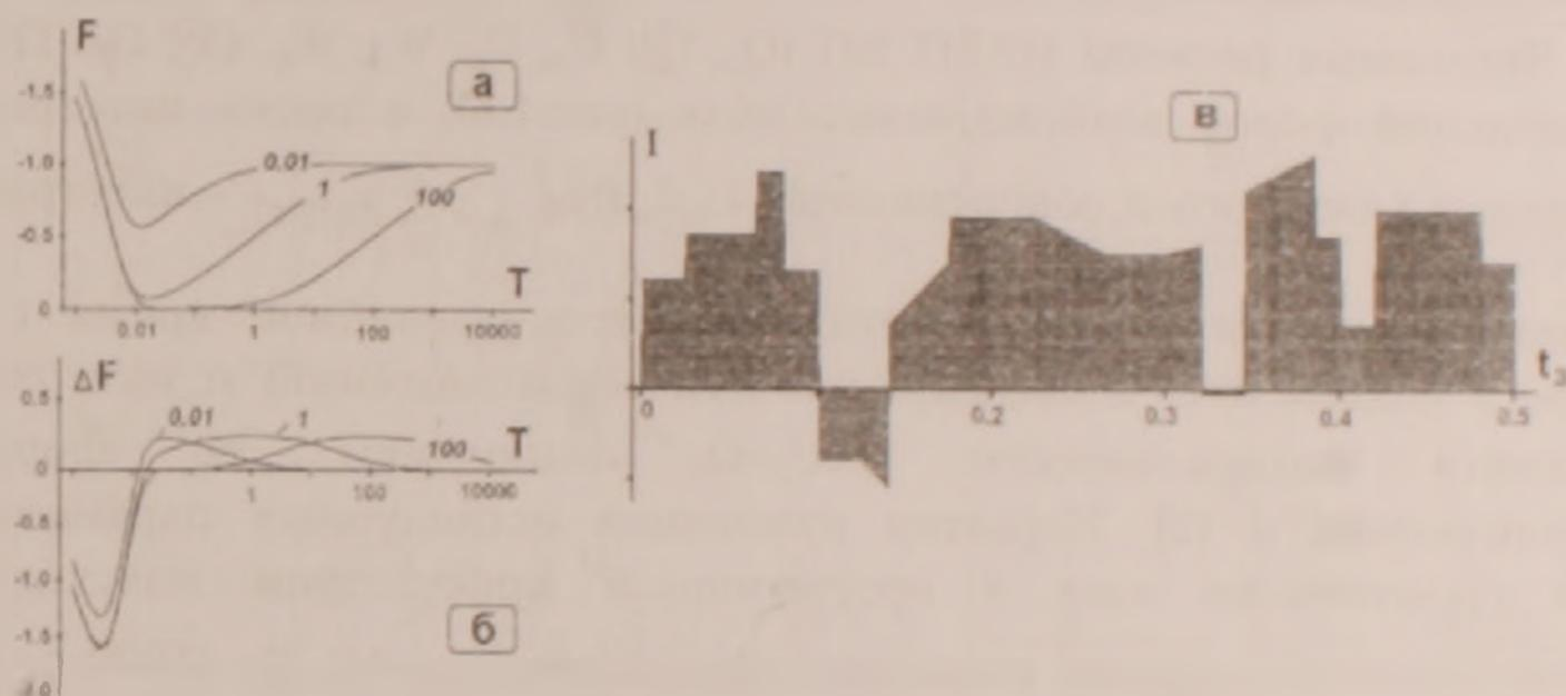
Рис.1. Исходные переходные характеристики вторичного поля (а) и их первые производные по десятичному логарифму времени (б). Шифр кривых —  $T_0$  (в секундах); (в) график рассматриваемого произвольного возбуждения электрического поля длительностью 0.5с.
