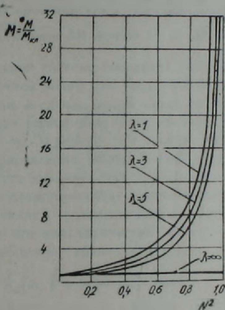
Рис. 2. Зависимости безразмерного момента всех сил вязкости  $M$  от  $N^2$  при различных  $\lambda$ .
