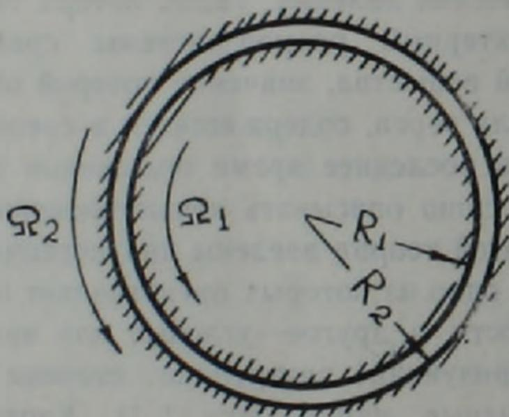
Рис. 1. Поперечное сечение вращающихся коаксиальных цилиндров
