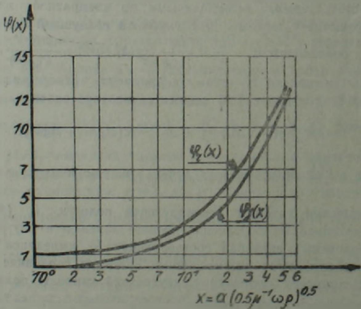
Рис. 3. Зависимость величин активных  $\psi_r(x)$  и реактивных  $\psi_a(x)$  компонент коэффициента вязкого сопротивления  $r(\omega) = r_r(\omega) + r_a(\omega)$  от величины  $x = a(0,5\omega\mu^{-1}\rho)^{0,5}$  в полулогарифмических координатах
