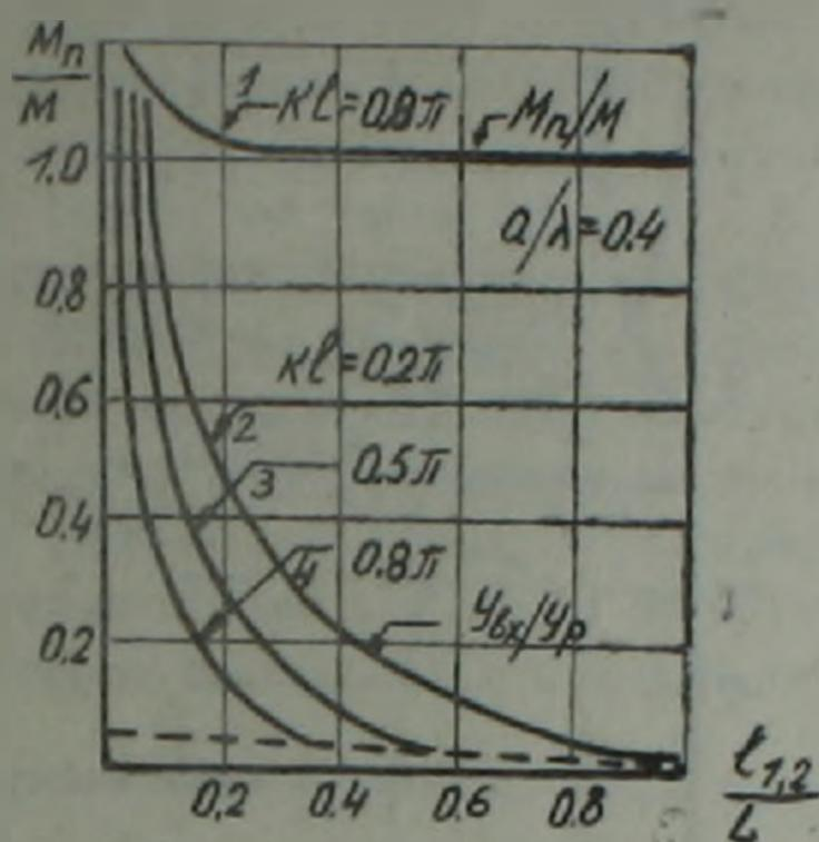
Рис. 1. Зависимость соотношения входных присоединенных масс  $M_1, M_2^{-1}$  (кривая 1) и тангенса  $y_{6x}/y_p$  входной и внутренней полости объемного звукопоглотителя в функции глубины полости  $l_{1,2}, L^{-1}$ , (кривые 2—4)
