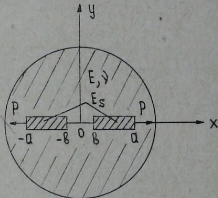
Рис. 2. Упругий круглый диск, усиленный двумя накладками
