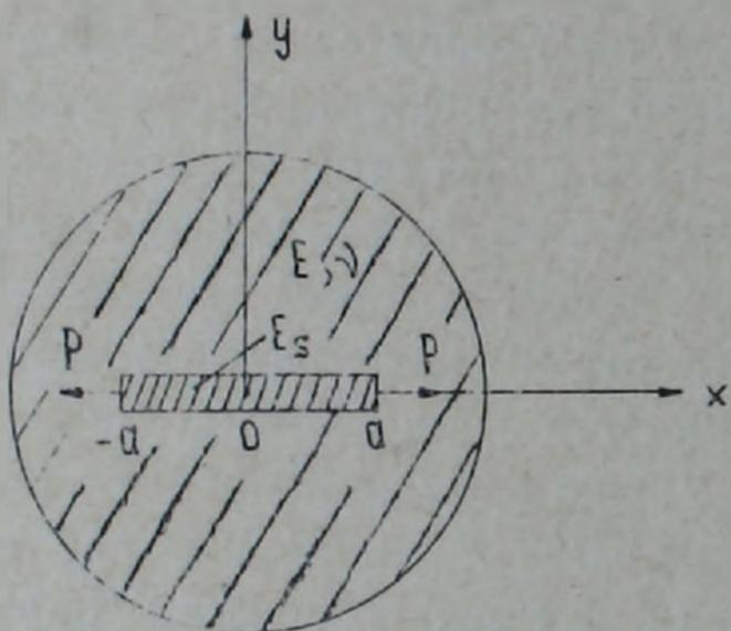
Рис. 1. Упругий круглый диск, усиленный одной накладкой
