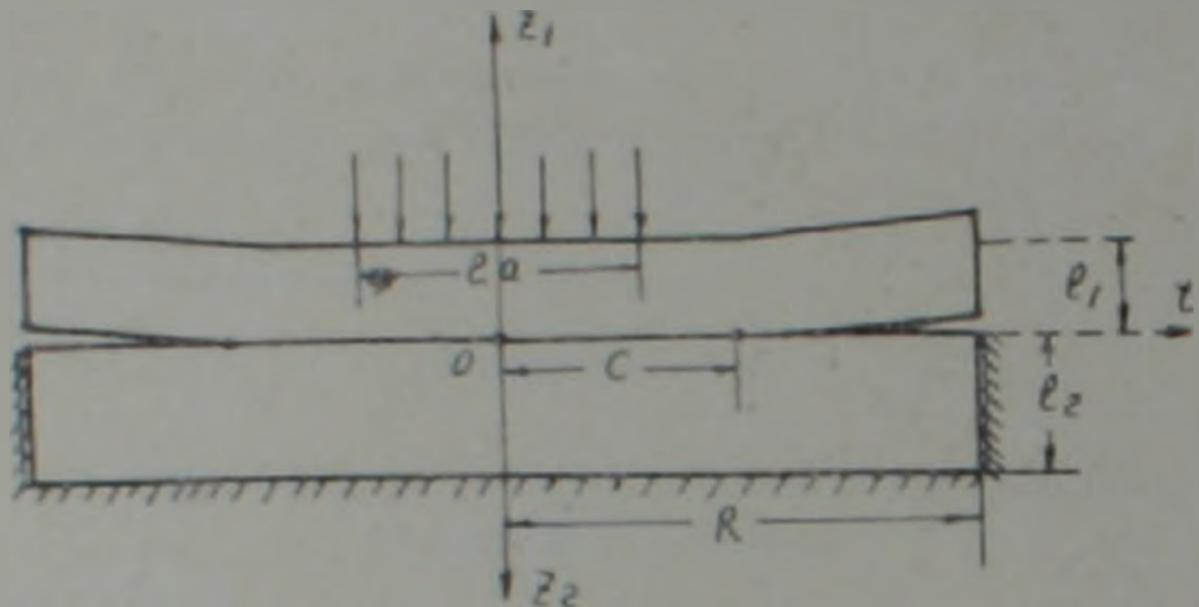
Рис. 1. Два цилиндра одинаковой длины и одинакового диаметра. На верхнем торце верхнего цилиндра приложена осесимметричная сжимающая нагрузка
