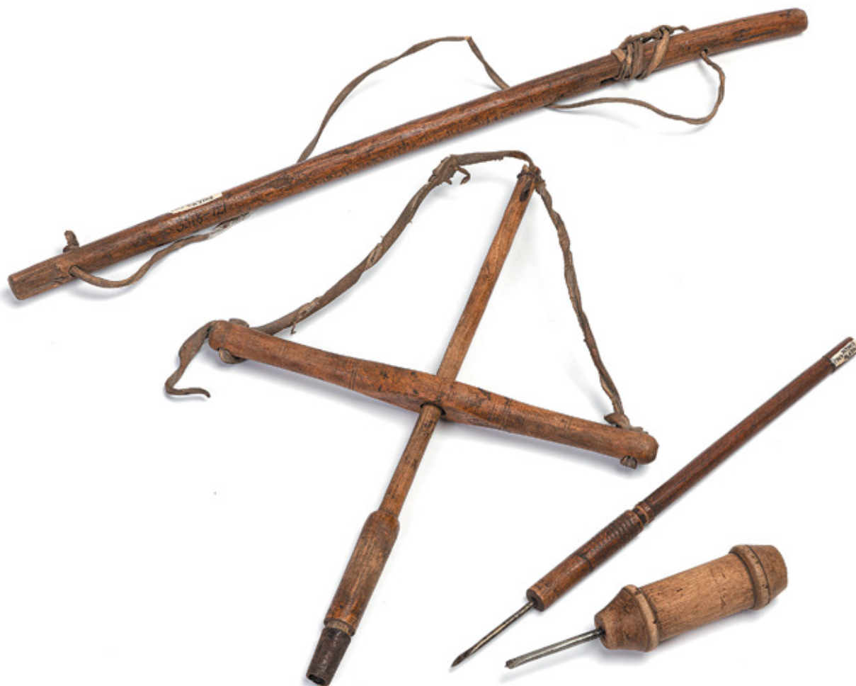
V.8-V.11 Инструменты для изготовления музыкальных инструментов: лучок для сверления, дрель, инструменты для сверления лучком Елисаветпольская губ., г. Шуши Конец XIX-начало XX в.
