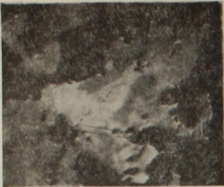
Фиг. 3. Агрегат зерен полисинтетически двойникованных кристаллов люцонита. Масляная иммерсия, николи X. Ув. 900.
