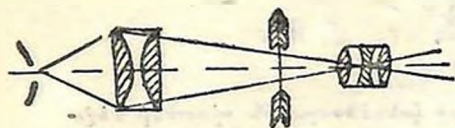
Նկ. 19. Ճառագայթների մուտքը կոնդենսորային աղեղնավոր լամպի մեջ:
