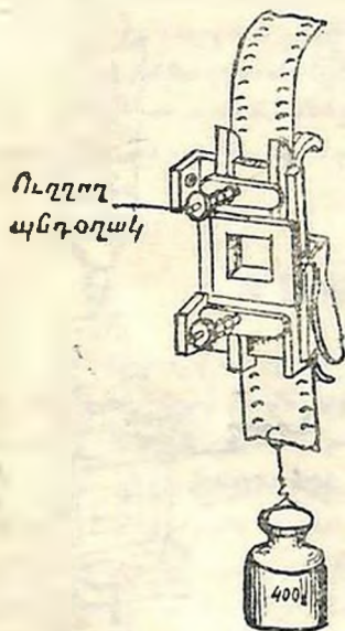
Նկ. 95. Ֆիլմի արգելակման կարգավորումը ֆիլմային ապսևտ՝ կշռաքարի միջոցով։
