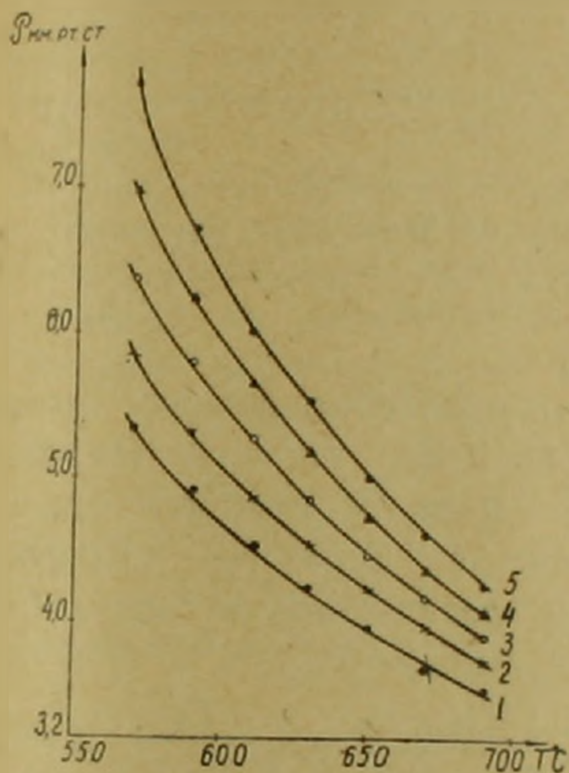
Фиг. 1. Зависимость первых пределов воспламенения смесей 2\text{H}_2 + \text{O}_2 + \text{XC}_2\text{H}_5\text{OH} от температуры. Значения X в %: 1—0,0; 2—0,50%; 3—1,0%; 4—1,5%; 5—2,0%.
