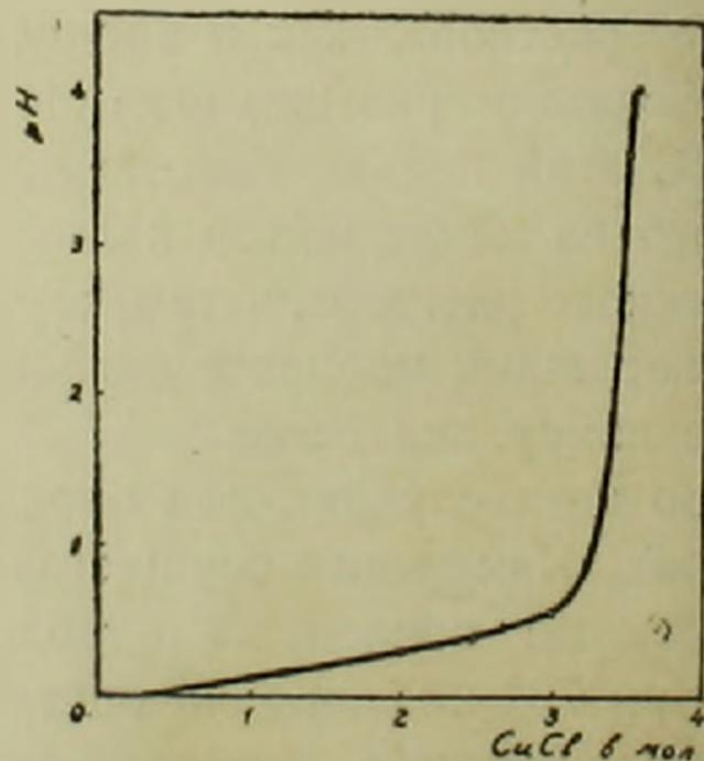
Рис. 2. Зависимость  $\text{pH}$  от концентрации  $\text{CuCl}$ .
