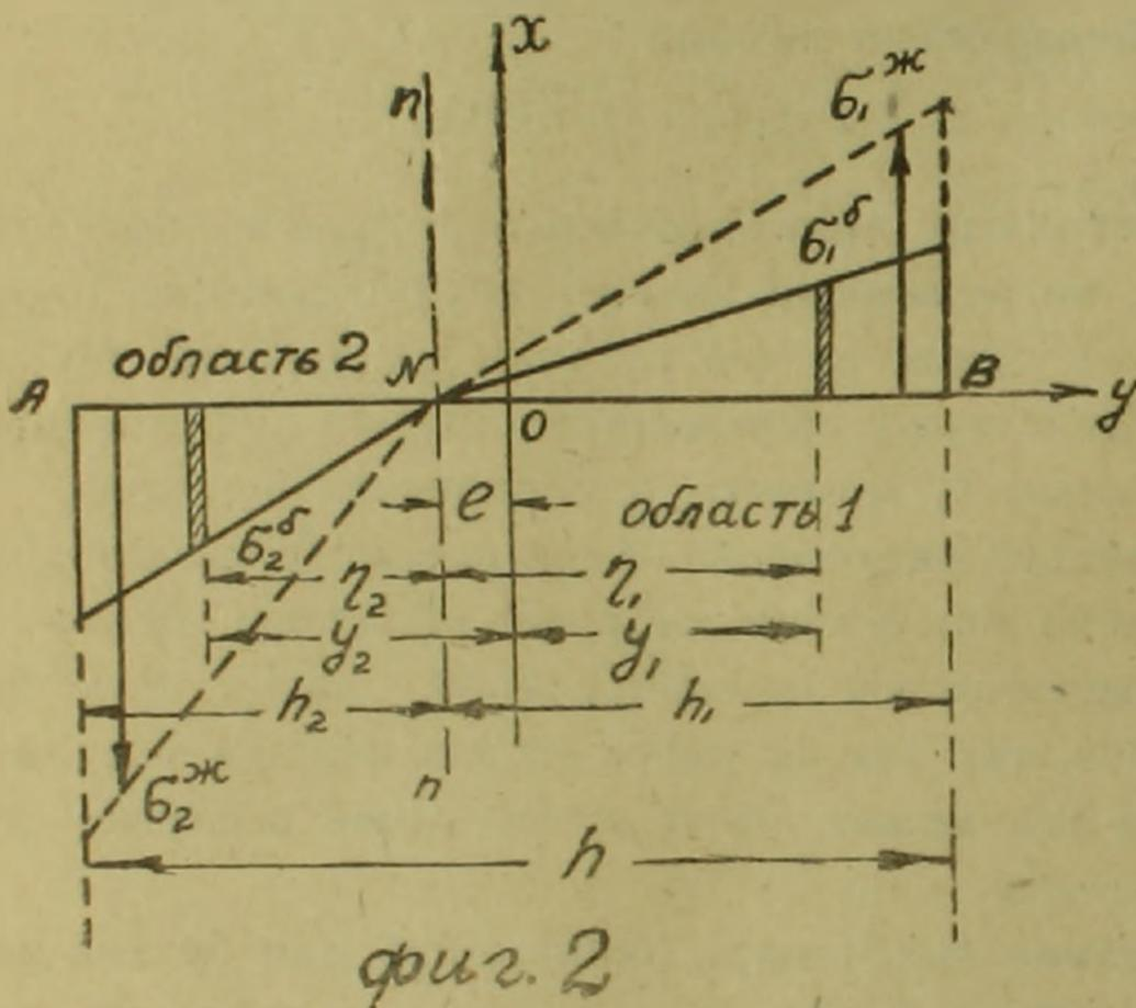
где  $\sigma^6$  — напряжение в бетоне,
