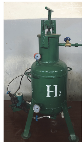
Նկ. 1. Դյուրակիր ջրածնային գեներատորի կառուցվածքի սխեմատիկական պատկերը (ձախ նկար) և ընդհանուր տեսքը (աջ նկար)
