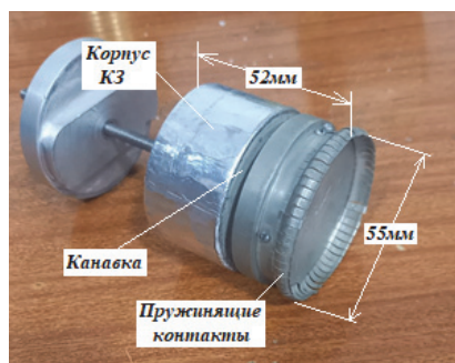
Рис. 3. Короткозамыкатель круглого волновода
