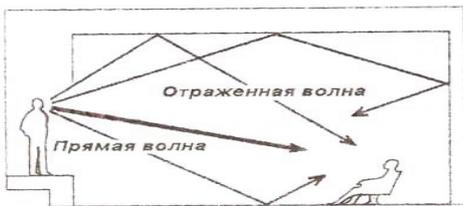
Рис. 6. Пути прямой и отраженных звуковых волн
