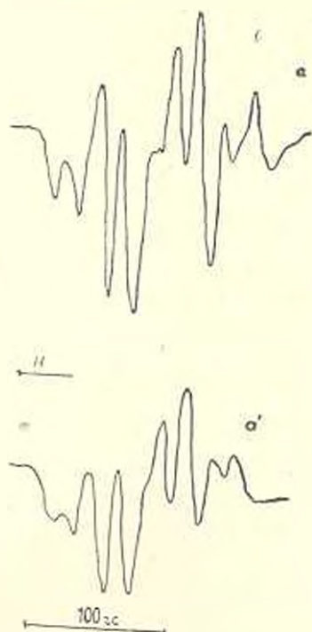
Рис. 1. Спектры ЭПР продуктов реакции атомов водорода с уранилом (а) и пшитозином (а').
