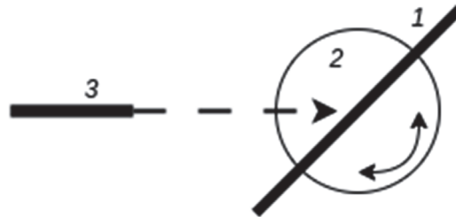
Рис.2. Схема экспериментальной установки для измерения относительного углового пропускания света в солнечный элемент: 1 — солнечный элемент; 2 — вращающийся стол; 3 — световод.
