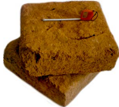
Fig. 11. Des briques crues carrées*
