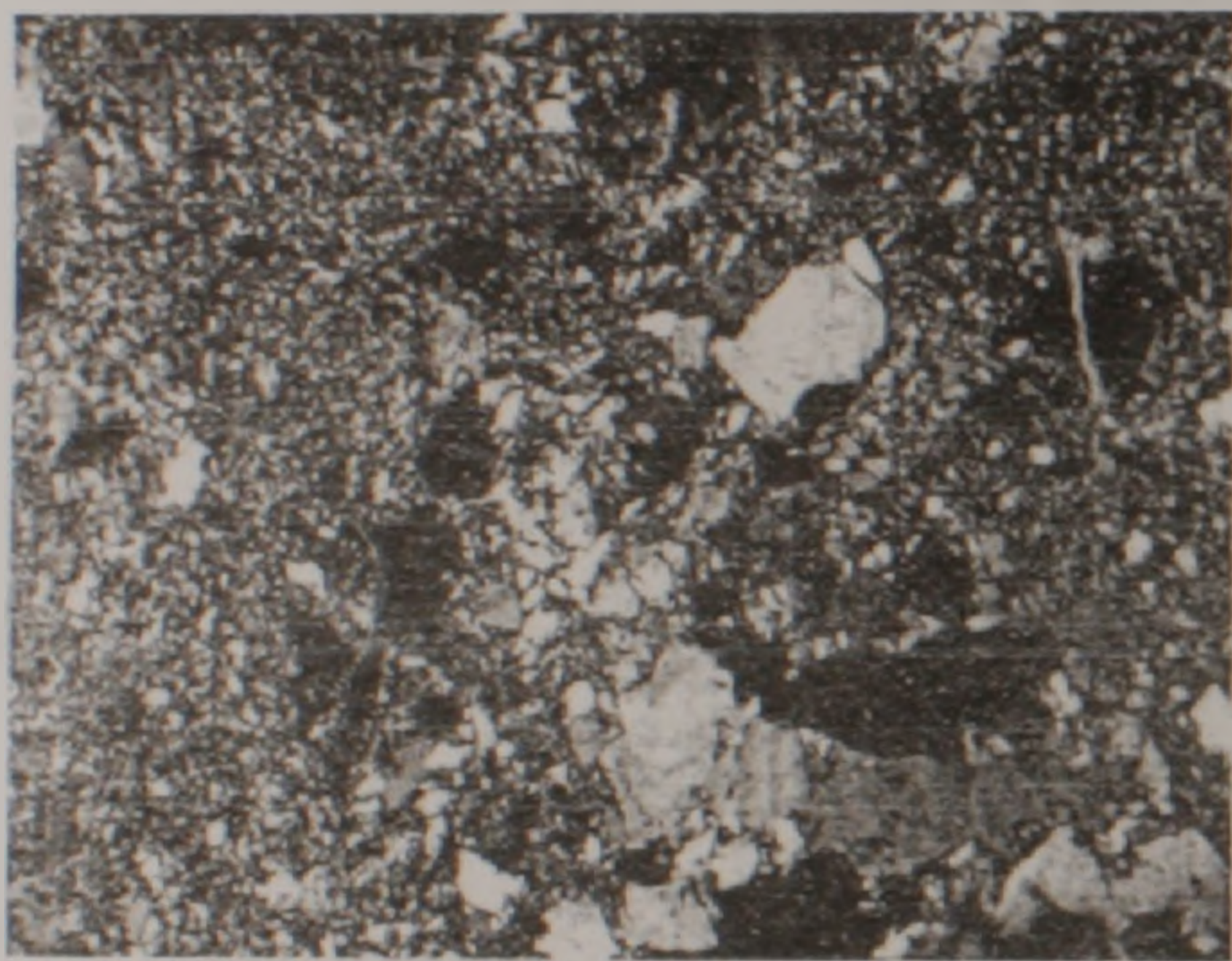
Рис.2. Гидротермально-измененный базальтовый андезит Тейского месторождения. Образец S-1. Ув. 50, николи +. Коорд X=1103663, Y=4319150
