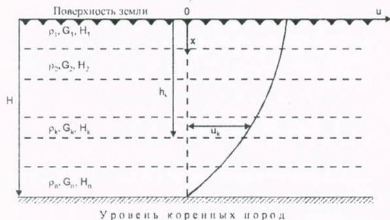
Рис. 1б. Расчетная схема неоднородной толщи.
