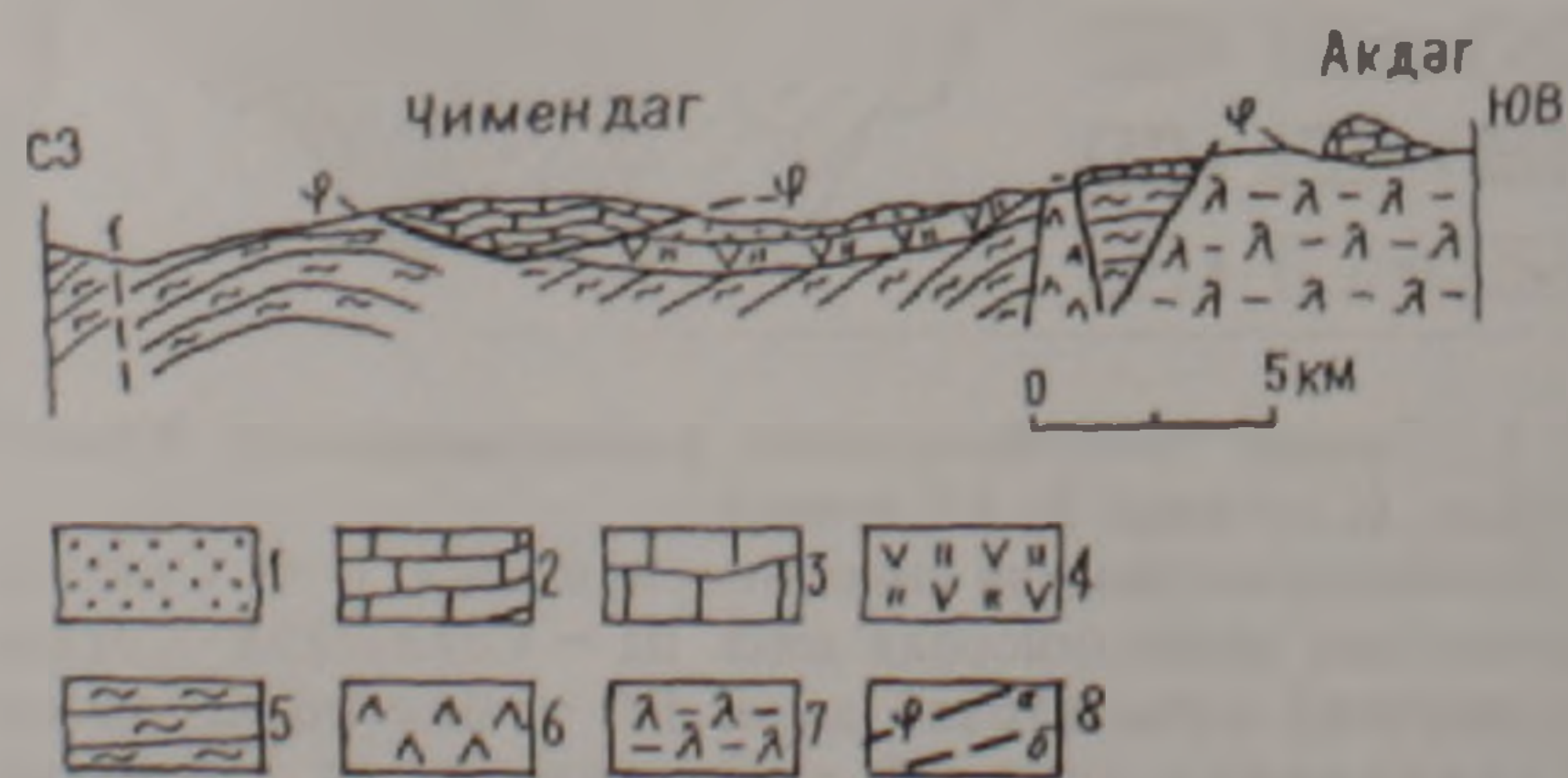
Рис. 2. Геологический разрез выходов офиолитовой серии района г. Эрзинджана (Эрзнка). (Составлен по данным Bergougnan (1976) с упрощениями). 1. Постофиолитовый комплекс (палеоген). 2. Известняки плитчатые микро- и мелкозернистые (чимендагская толща). Верхняя юра-неоком. 3. Известняки раннего мела, мелководная фация, комплекс Мунзурдаг. 4. Эффузивно-радиоляритовая меланжированная толща. Верхняя юра-ранний мел (формация Караяпрак). 5. Вулканогенно-осадочная толща. Лейас. Формация Келкит. 6. Экструзии. 7. Серпентинизированные ультрабазиты. 8. а – основание надвигов, б – разломы.
