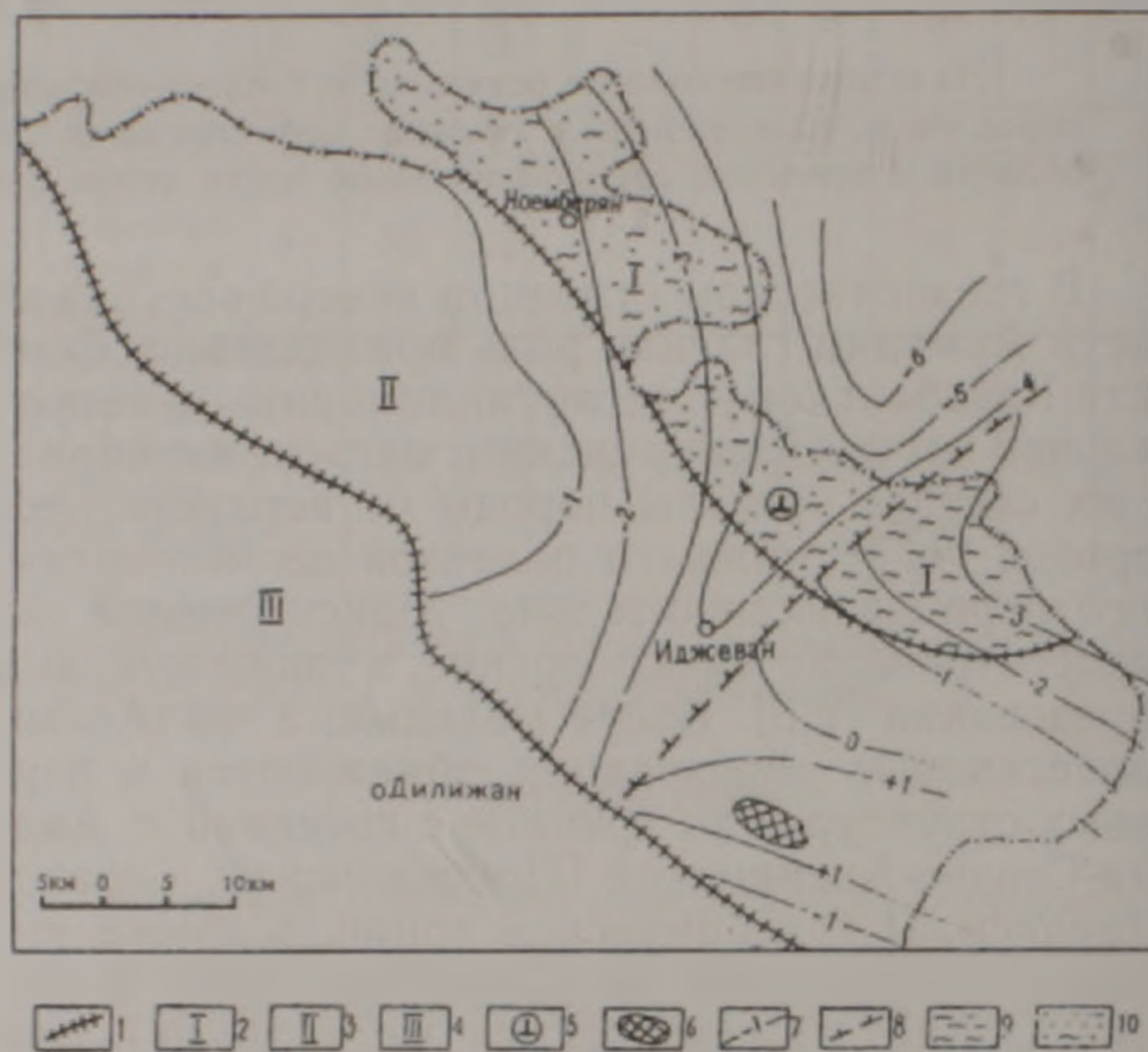
Рис 1 Карта перспектив нефтегазоносности северо-восточной части территории Армении. Условные обозначения 1 Границы главных тектонических элементов; 2 Прикуринская тектоническая зона; 3 Сомхето-Карабахская тектоническая зона; 4 Севано-Ширакский синклинорий; 5 Иджеванский синклинорий; 6 Выходы герцинского метаморфического фундамента; 7. Условные изолинии поверхности кристаллического фундамента в км; 8. Главнейшие разломы по геолого-геофизическим данным; 9 Перспективные площади по юрским отложениям; 10 Перспективные площади по меловым и юрским отложениям
