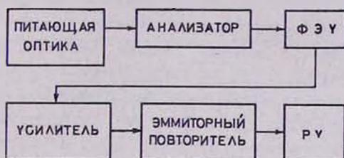
Рис. 2. Блок-схема звездного фотогида.
