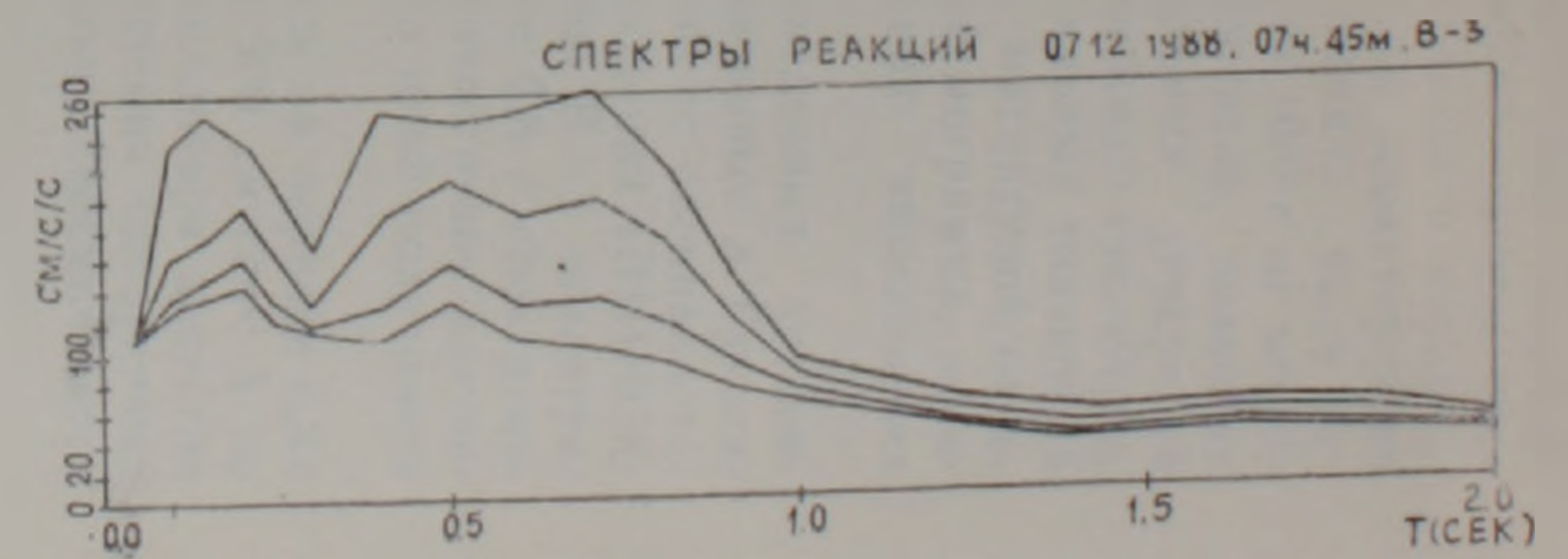
Рис. 6. Оцифрованные акселерограммы и спектры приведенных ускорений трех компонентов интенсивных колебаний, записанные в Гурьевске. а) 07 ч. 41 м.; б) 07 ч. 45 м.
