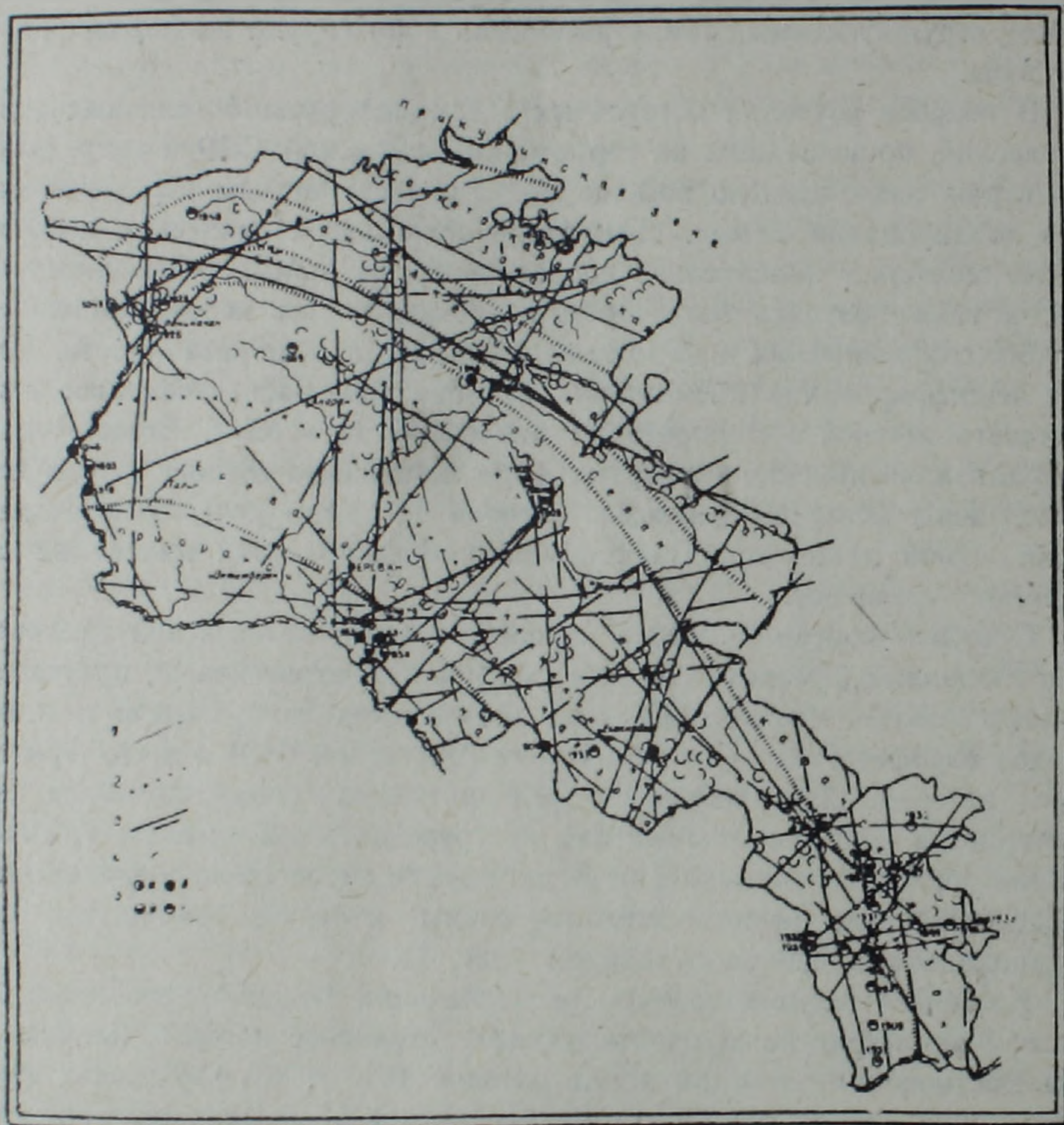
Рис. 1. Схема линеаментов и предполагаемых сейсмодислокаций территории Армянской ССР. 1—границы тектонических зон (тектоническое районирование по А. Т. Асланяну); 2—граница между эвгеосинклинальной и миеосинклинальной областями Армянской ССР; 3—линеаменты и линеаментные зоны Армянской ССР (по А. С. Караханяну и Х. О. Саргсяну); 4—предполагаемые сейсмодислокации; 5—эпицентры землетрясений: а—8—9-балльных; б—8-балльных; в—7-балльных; г—6-балльных.
