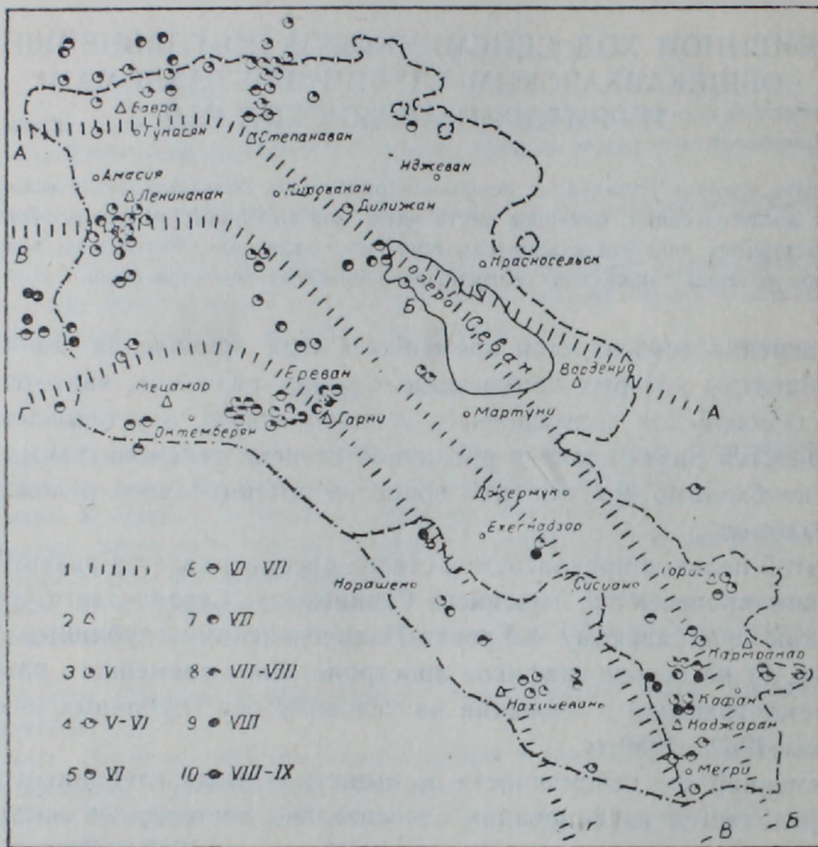
Рис. 1. Схема расположения Амасийско-Севанского, Севано-Зангезурского, Ленинанкан-Ордубадского, Ереван-Нахичеванского глубинных разломов, сейсмостанций и эпицентров сильных землетрясений на территории Армянской ССР и Нахичеванской АССР за 735—1976 гг. [14] с показом интенсивности в баллах (по MSK-64). 1—Глубинные разломы общекавказского простира- нения, выделенные по геолого-геофизическим данным (цифрами на схеме обозначены глубинные разломы: 1—1-Амасийско-Севанский; 2—2-Севано-Зангезурский, 3—3-Ленинанкан-Ордубадский, 4—4-Ереван-Нахичеванский), с показом ширины зон разломов, по которым велся подсчет землетрясений; 2—сейсмо- станции; 3—8-эпицентры землетрясений с интенсивностью V—IX баллов.
