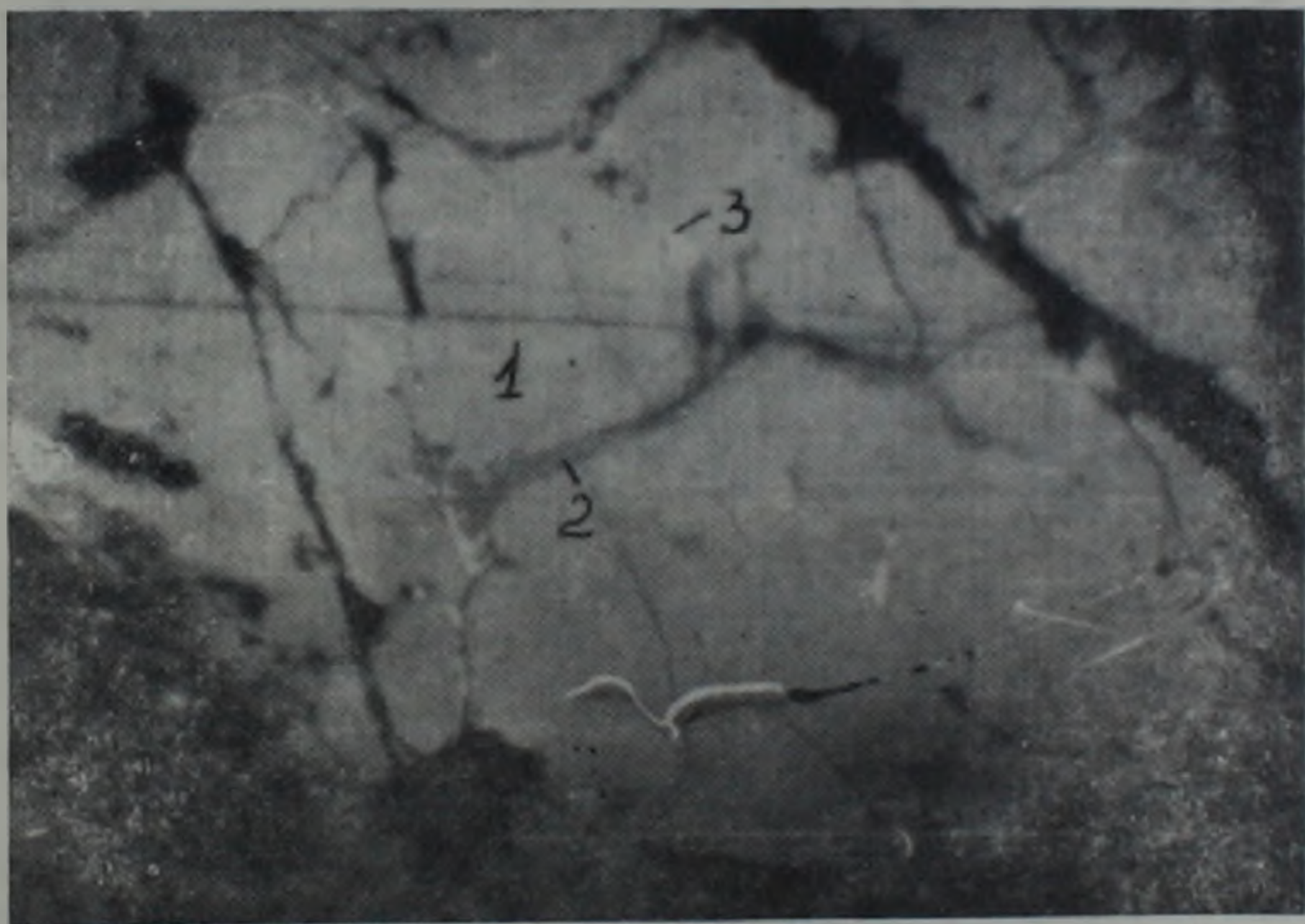
Рис. 2. Микроструктура штейна плавки. 1—пирротин, 2—магнетит, 3—металлическое железо. Пол шл. Ув. 250 х.
