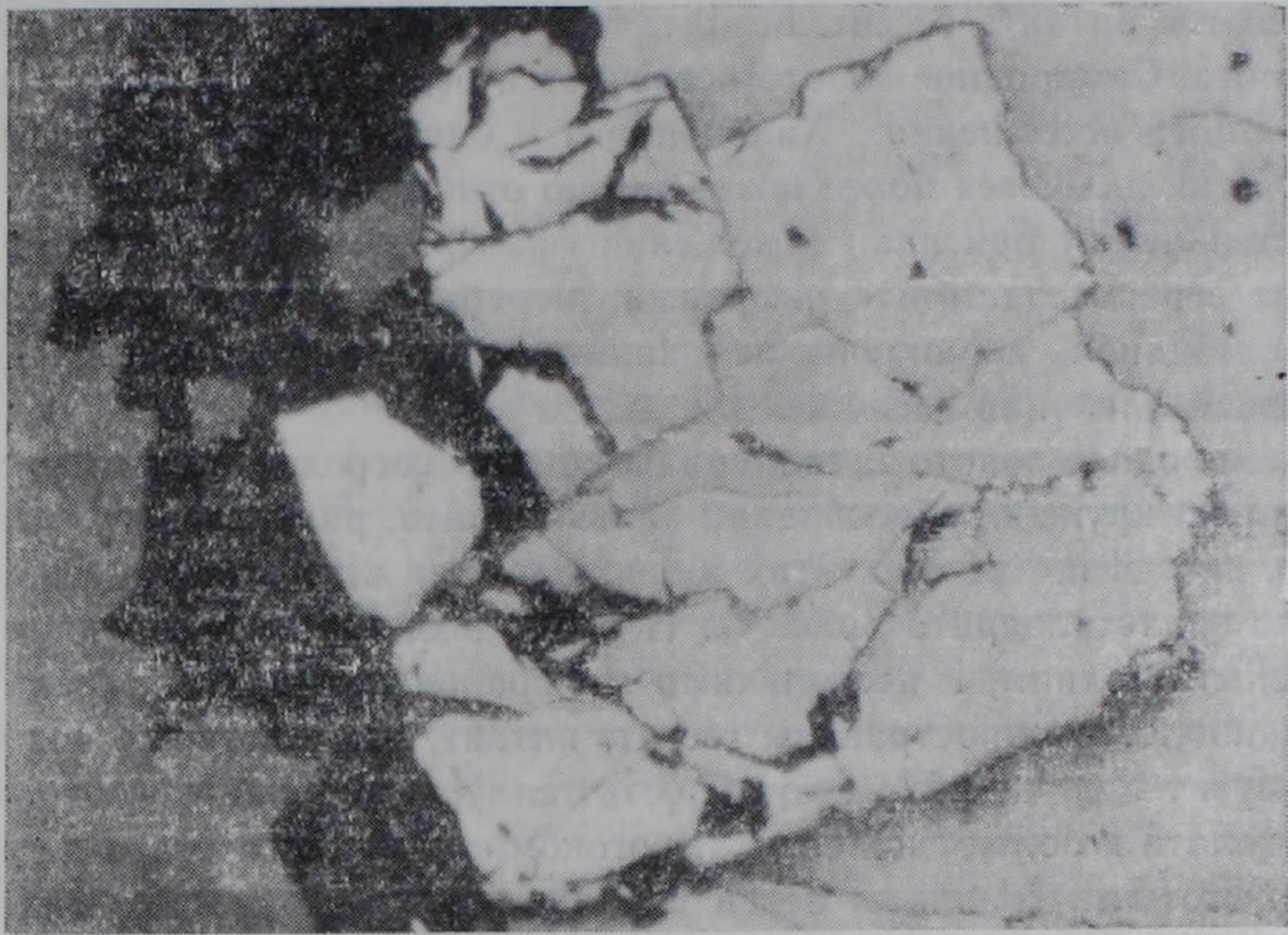
Рис. 2. Раздробленный пирит (белое), залеченный прожилками сфалерита (серое), халькопирита (светло-серое) и кварца (темное). Полированный шлиф. Увел. 165.
