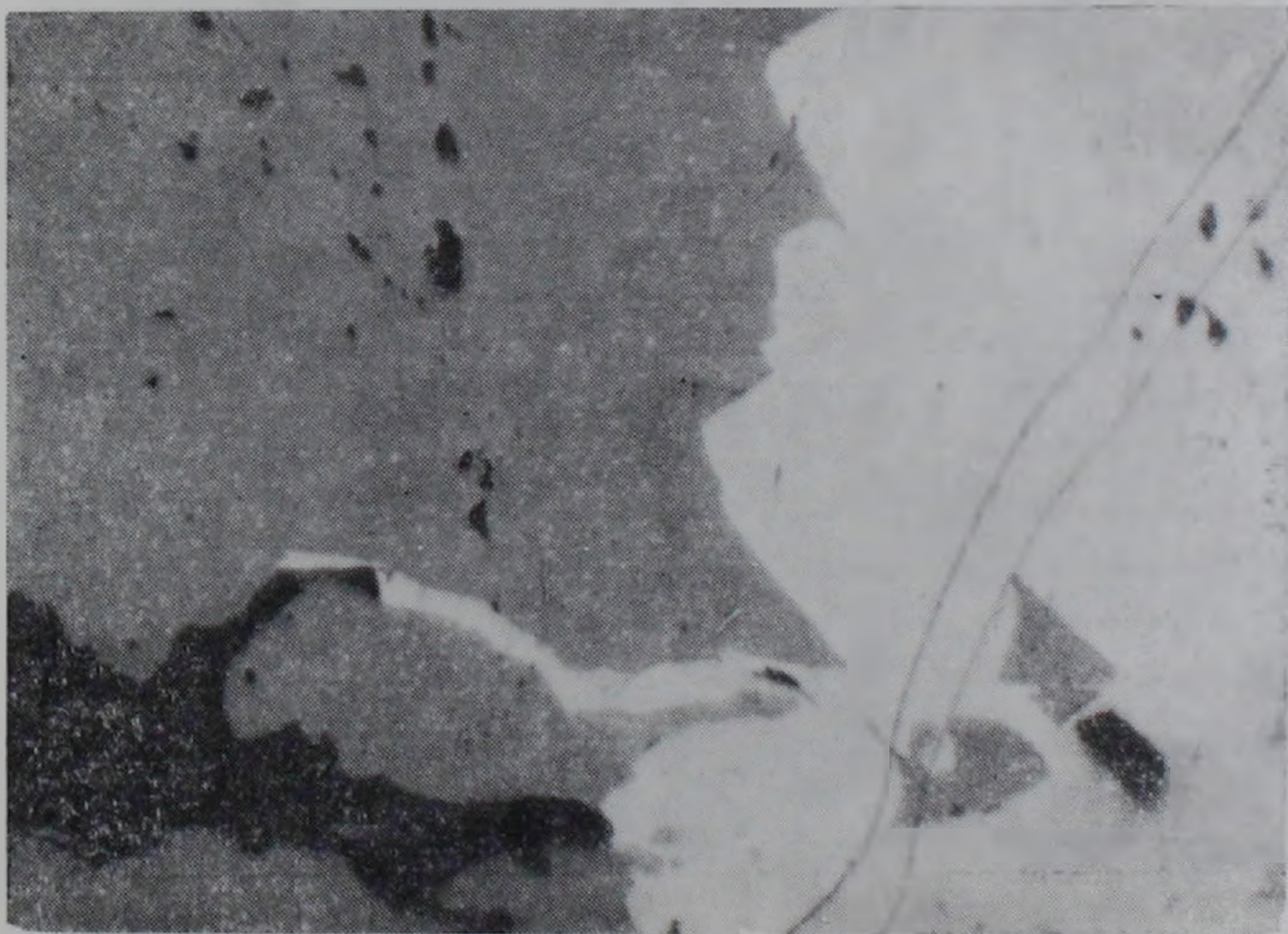
Рис. 3. Характер замещения сфалерита (серое) кварцем (темное) и халькопиритом II (светлое). Эмульсиевидная вкрапленность халькопирита концентрируется по границе сфалерита и замещающих его минералов. Полированный шлиф. Увел. 165.
