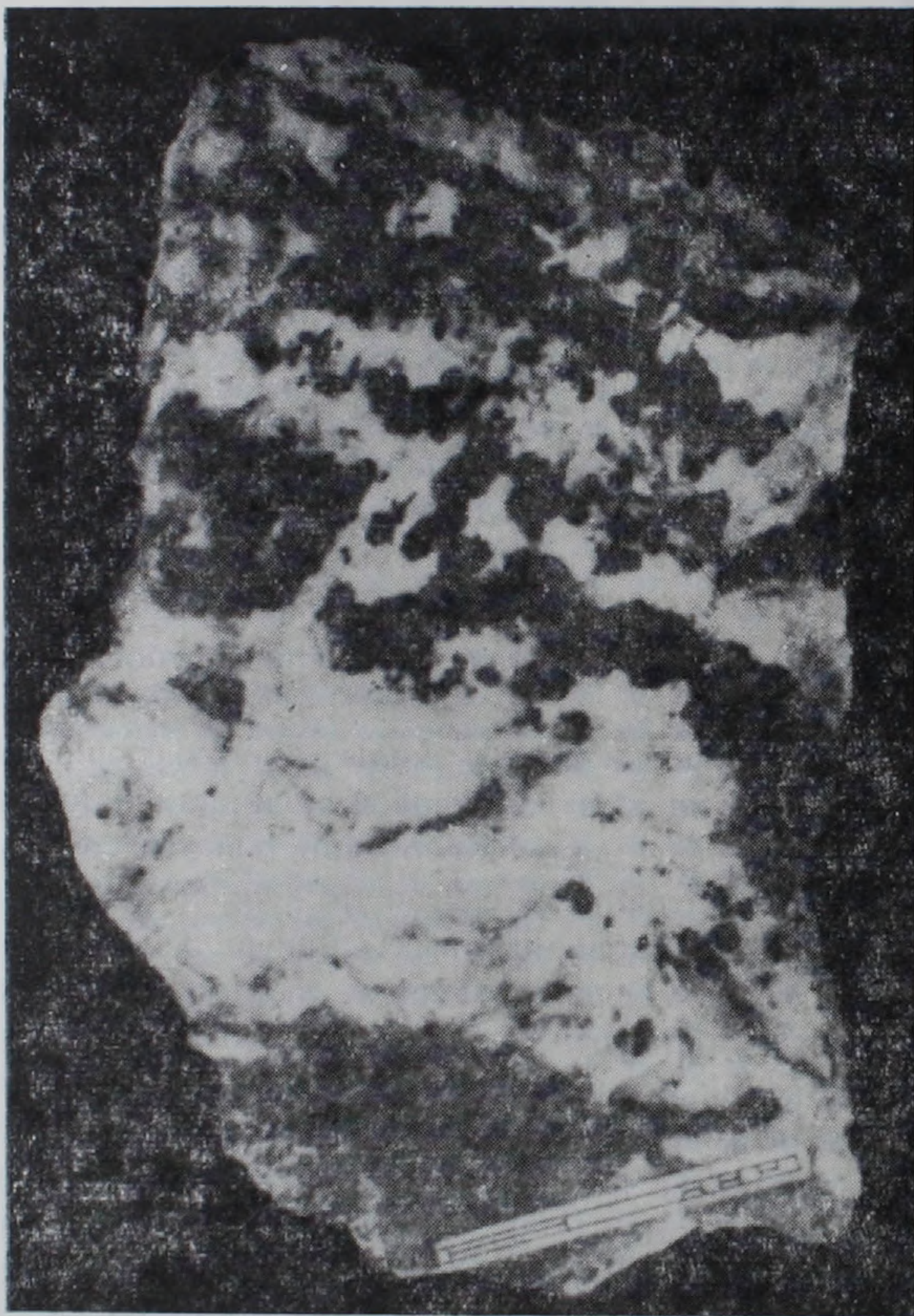
Рис. 2. Вкрапленно-полосчатая текстура: темное—сфалерит-галениновые агрегаты с халькопиритом, белое—барит. Обр. 228, жила 5, шт. 9. Месторождение Зуйг-джрагац.
