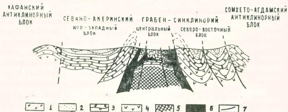
Рис. 2. Принципиальный профиль Севано-Акеринского грабен-синклинория. 1. Сеноман, эффузивно-осадочный комплекс. 2. Альб-сеноман, песчано-глинистые флиционидные отложения. 3. Верхняя юра-неоком, вулканиты, известняки. 4. Средняя юра, вулканиты. 5. Докембрий-нижний палеозой, метаморфические сланцы. 6. Гипербазиты, габбро. 7. Разрывы.
