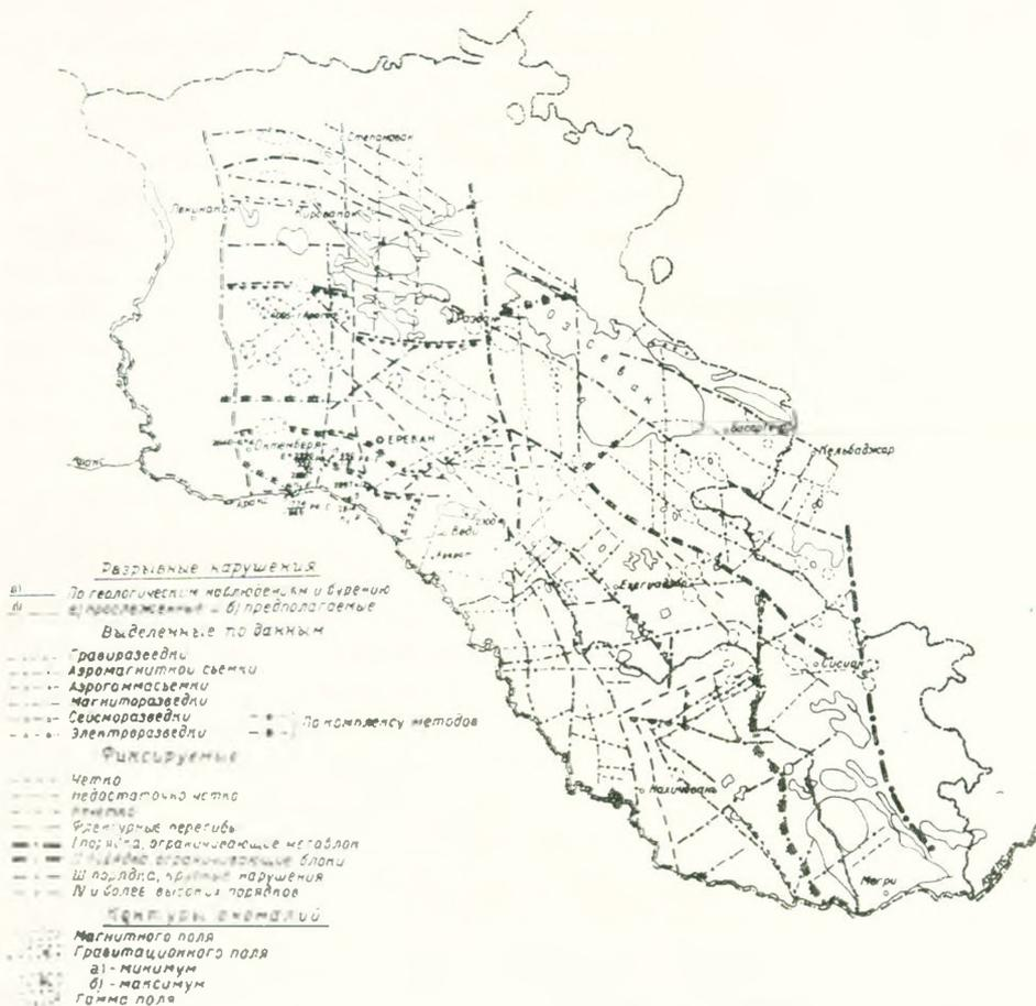
Фиг. 2. Схема разрывной тектоники по геофизическим данным (условные обозначения на схеме). Тонкими линиями показаны контуры интрузивных тел.
