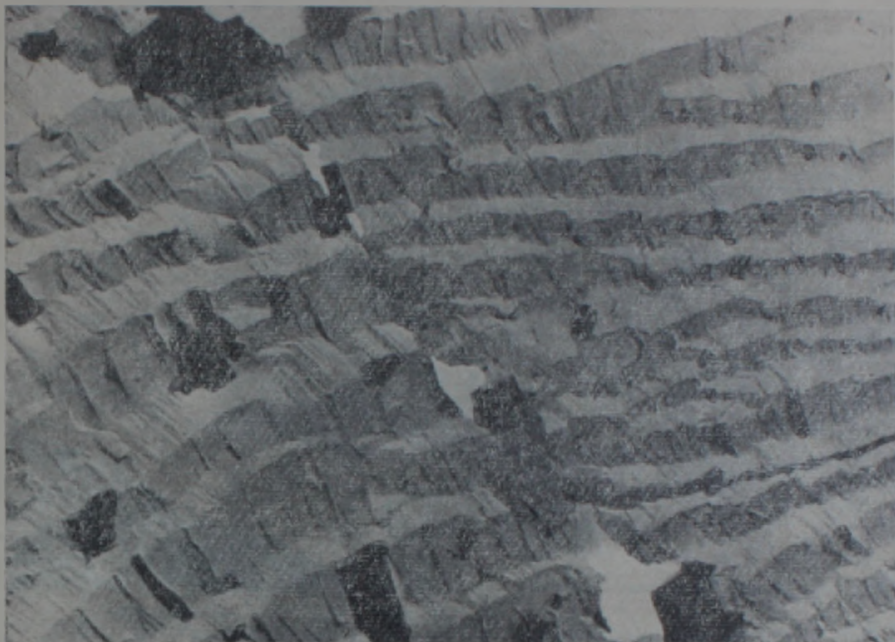
Фиг. 7. Электронно-микроскопический снимок скола сфалерита. Ув. 24000, среда роста \text{NH}_4\text{Cl} —10%.
