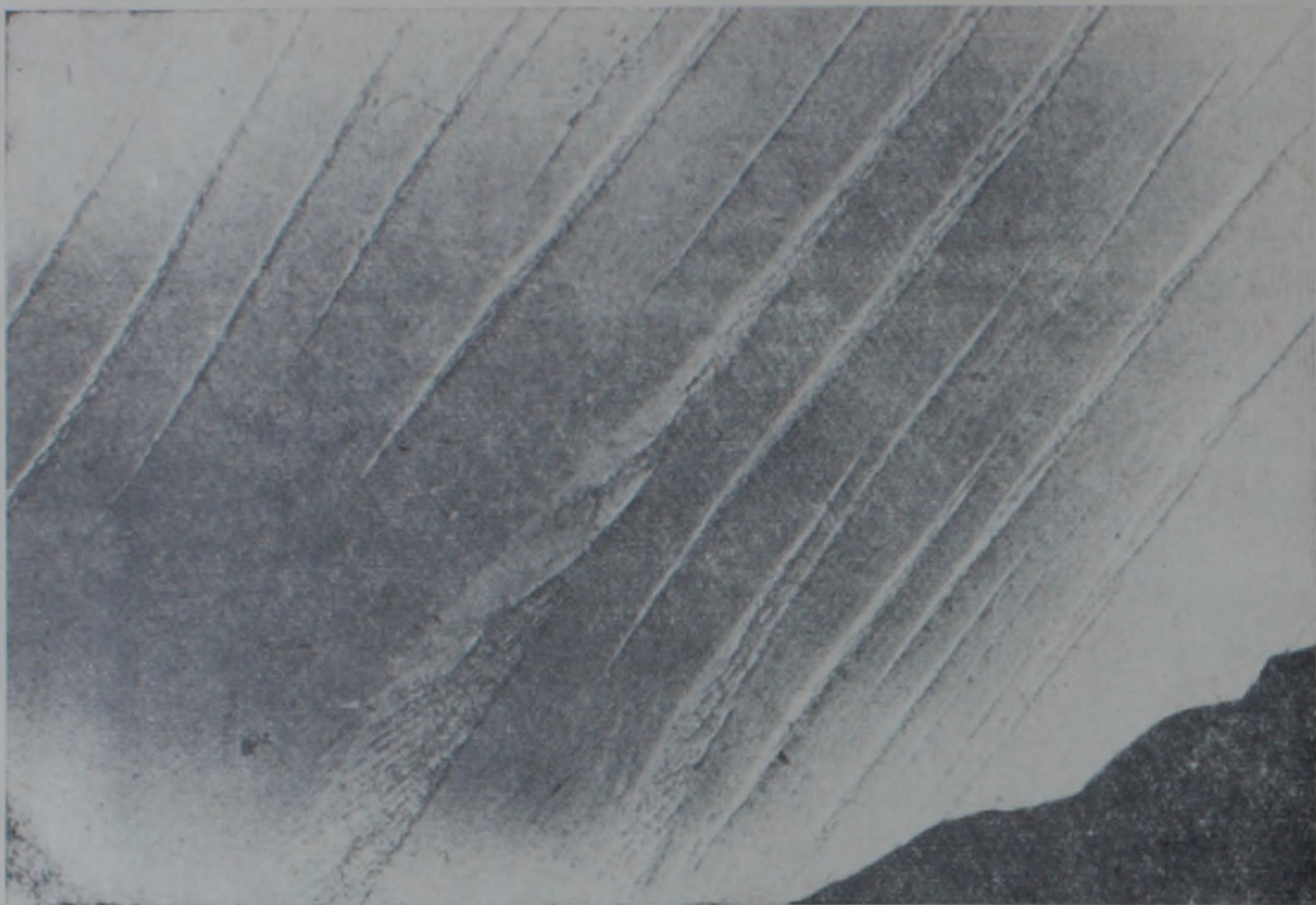
Фиг. 9. Электронно-микроскопический снимок скола сфалерита. Ув. 24000, среда роста КОН—35%.
