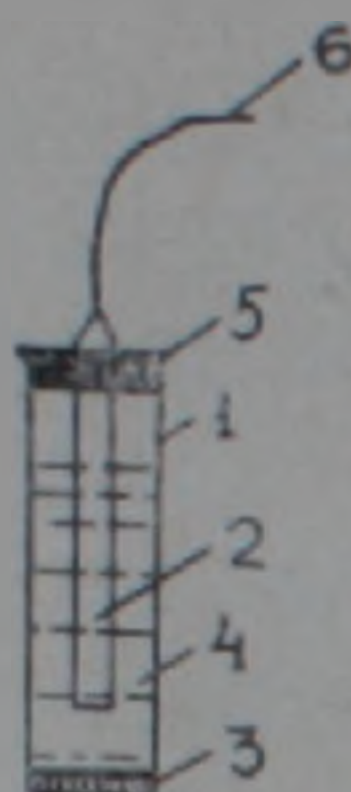
Фиг. 1. Неполяризующийся хлорсеребряный электрод.
