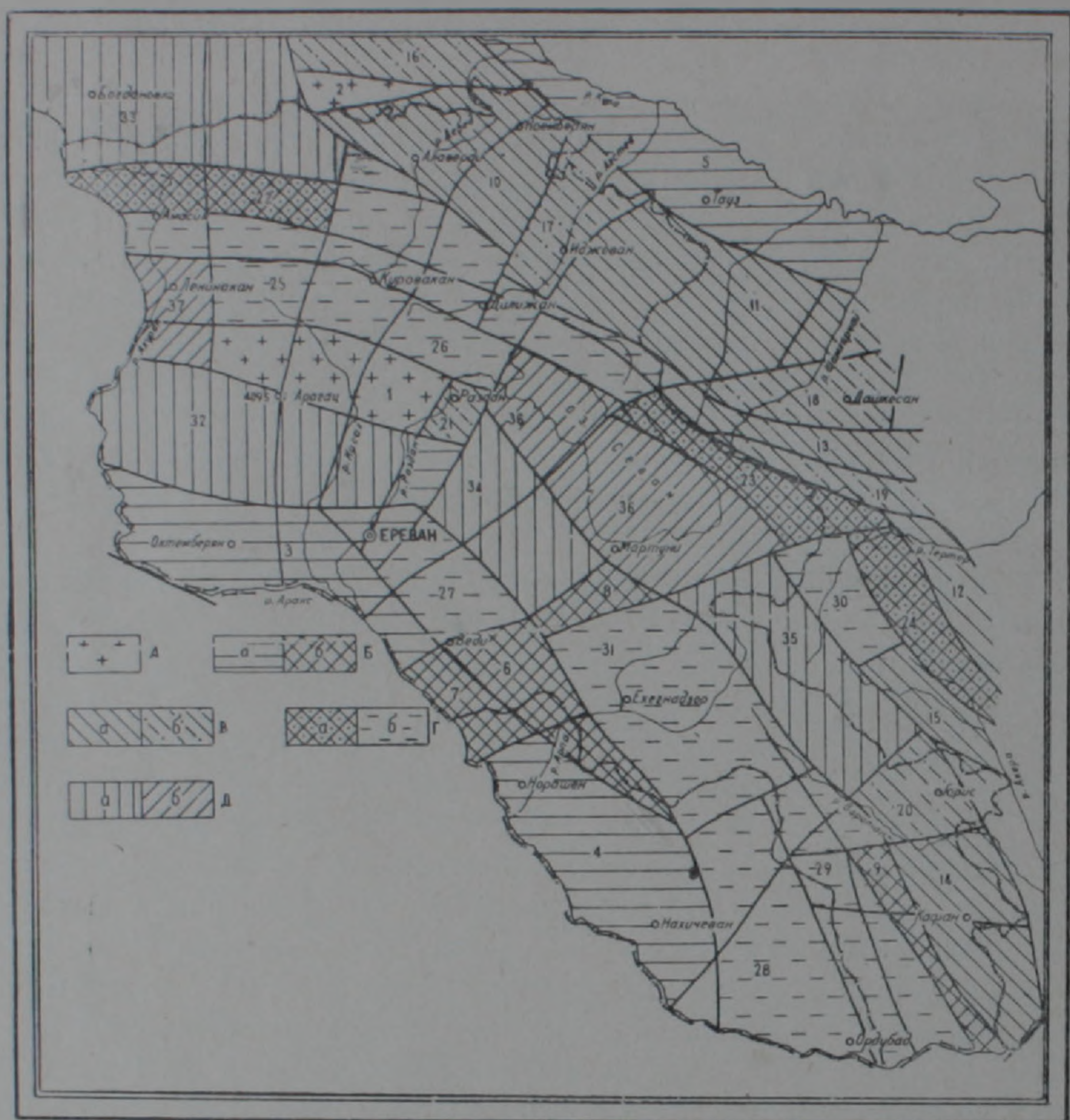
Фиг. 3. Схема блокового строения территории Армянской ССР и прилежащих частей Малого Кавказа. А. Блоки первичные, не испытавшие обращения (выступы байкальского основания): 1—Цахкуняцкий; 2—Локский. Б. Блоки эпибайкальской консолидации (эпибайкальская квазиплатформа). а—Испытавшие интенсивное прогибание в неоген-четвертичное время (межгорные прогибы грабен-синклинорного типа); 3—Среднеараксинский; 4—Нахичеванский; 5—Куринский. б—Приподнятые обломки квазиплатформы: 6—Урцкий; 7—Садаракский; 8—Аргичинский; 9—Гехинский. В. Блоки нижнеюрского заложения: а—Изометрично-удлиненные антиклинорного типа: 10—Алавердский; 11—Шамшадинский (Шамхорский); 12—Карабахский; 13—Мровдагский; 14—Кафанский; 15—Лачинский. б—Поперечные и широтные синклинорного типа, испытавшие погружение в поздней юре-неокоме и поднятие в палеогене: 16—Болисский; 17—Иджеванский; 18—Дашкесанский; 19—Тоургачайский; 20—Горисский (Гочасский); 21—Разданский. Г. Блоки мелового заложения: а—Изометрично-удлиненные антиклинорного типа, испытавшие погружение в меле и поднятие в палеогене (офиолитовые блоки): 22—Западно-базумский; 23—Восточносеванский; 24—Верхнеакеринский. б—Удлиненные синклинорного типа, испытавшие погружение в меле и палеогене и поднятие в конце палеогена: 25—Спитакский; 26—Кироваканский; 27—Вединский; 28—Ордубадский; 29—Каджаранский; 30—Кельбаджарский; 31—Ехегнадзорский. Д. Блоки молодые (неоген-четвертичные): а—Очаговые (вулканические): 32—Арагацкий; 33—Ахалкалакский; 34—Гегамский; 35—Ишхансарский. б—Наложенные грабен-синклинального типа: 36—Севанский; 37—Ширакский.
