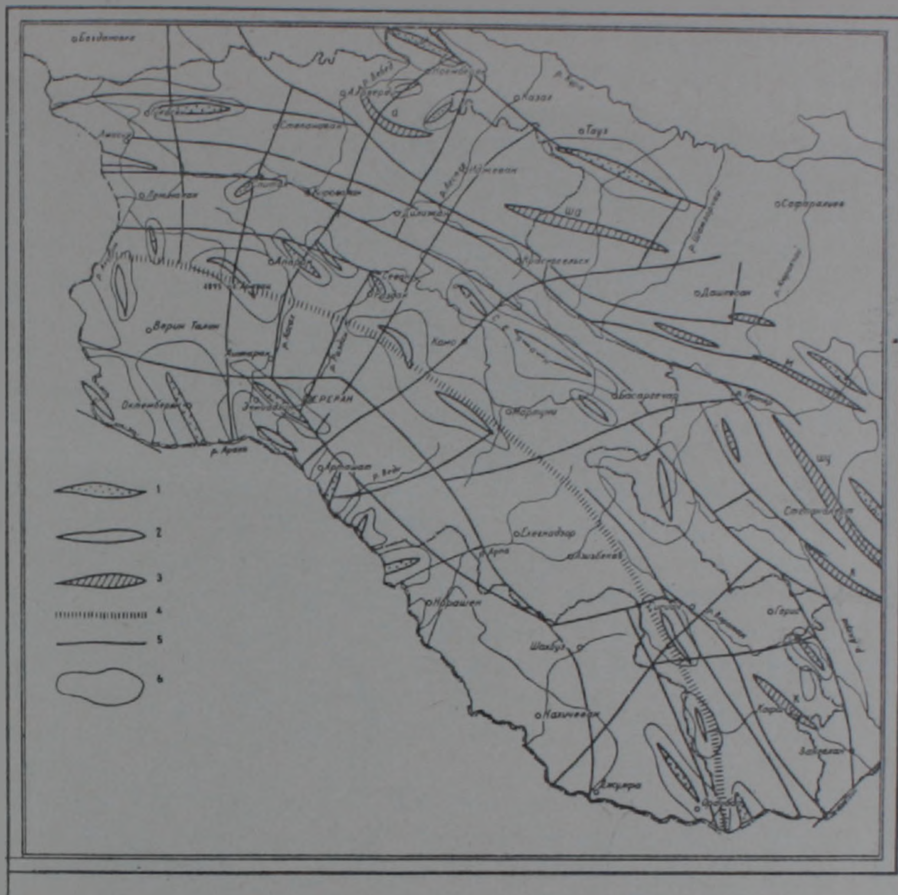
Фиг. 1. Схема сопоставления основных элементов гравитационного поля и современной структуры территории Армянской ССР и смежных районов Малого Кавказа. 1—оси локальных максимумов силы тяжести; 2—оси локальных минимумов силы тяжести; 3—оси нижнеальпийских локальных блоков; а—Алавердский, ша—Шамшадинский, м—Муровдагский, шу—Шушинский, л—Лачинский, к—Кафанский; 4—структурные швы; 5—границы блоков (продольные и поперечные разломы); 6—границы локальных аномалий силы тяжести.
